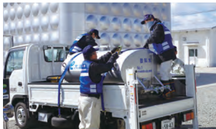
給水タンクをトラックに固定します
